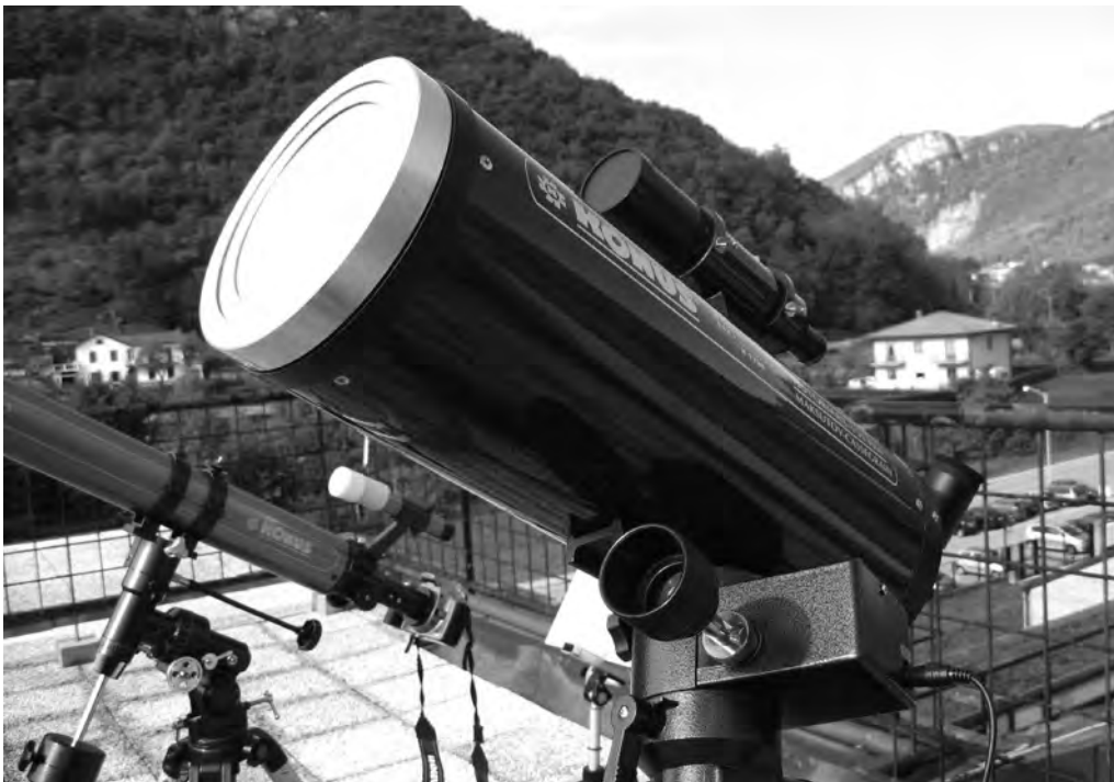
Primo piano del riflettore Maksutov 150/1800 puntato verso il Sole (strumento non stazionato).
